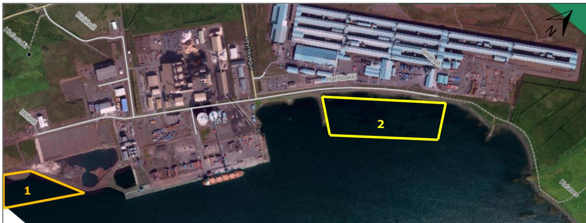
Mynd 1.1 Núverandi flæðigryfjur og flæðigryfjur sem eru mögulegar á svæðum 1 og 2. Sjá má núverandi flæðigryfjur hægra megin við svæði 1. Elstu flæðigryfjurnar eru aflokaðar innan núverandi hafnarsvæðis.
